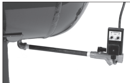
Figura 11 - Drenaje automático del tanque
